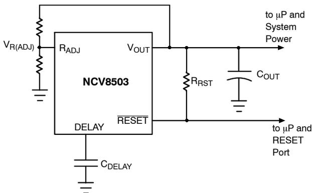
Figure 16. Adjustable  $\overline{\text{RESET}}$
