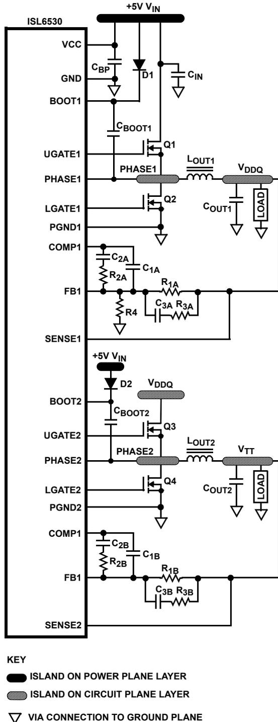
FIGURE 7. PRINTED CIRCUIT BOARD POWER PLANES AND ISLANDS
