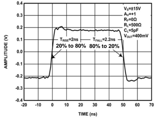
FIGURE 24. SMALL SIGNAL RISE AND FALL TIMES
