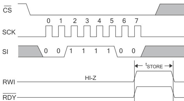
**Figure 29. Software RECALL Cycle** <sup>[19]</sup>
