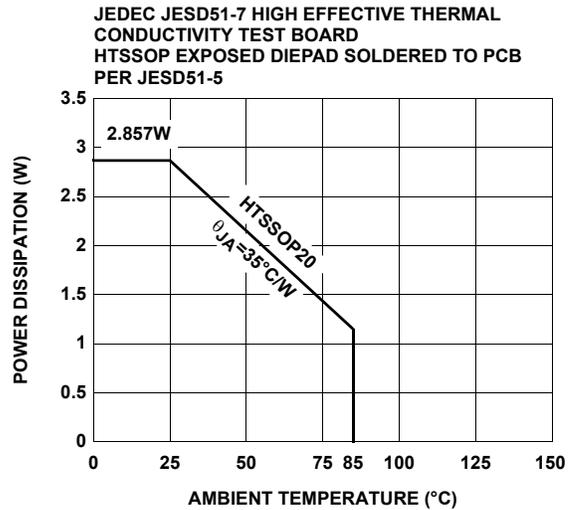
FIGURE 30. PACKAGE POWER DISSIPATION vs AMBIENT TEMPERATURE
