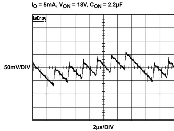
FIGURE 16.  $V_{ON}$  RIPPLE
