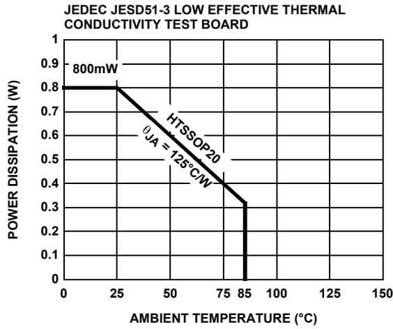
FIGURE 31. PACKAGE POWER DISSIPATION vs AMBIENT TEMPERATURE
