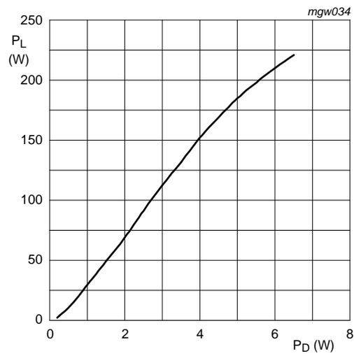
$V_{DS} = 36 \text{ V}$ ;  $I_{Dq} = 150 \text{ mA}$ ;  $f = 1060 \text{ MHz}$ ;  $t_p = 50 \text{ }\mu\text{s}$ ;
