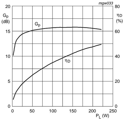
$V_{DS} = 36 \text{ V}$ ;  $I_{Dq} = 150 \text{ mA}$ ;  $f = 1060 \text{ MHz}$ ;  $t_p = 50 \text{ }\mu\text{s}$ ;
