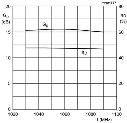
$V_{DS} = 36\text{ V}$ ;  $I_{Dq} = 150\text{ mA}$ ;  $P_L = 200\text{ W}$ ;  $t_p = 50\text{ }\mu\text{s}$ ;  $\delta = 2\%$
