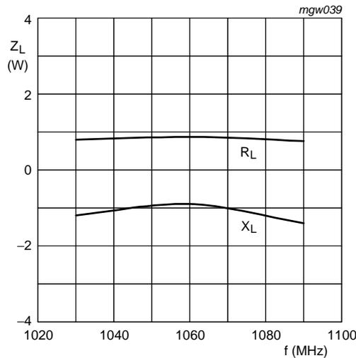
$V_{DS} = 36\text{ V}$ ;  $I_{Dq} = 150\text{ mA}$ ;  $P_L = 200\text{ W}$ ;  $t_p = 50\text{ }\mu\text{s}$ ;  $\delta = 2\%$
