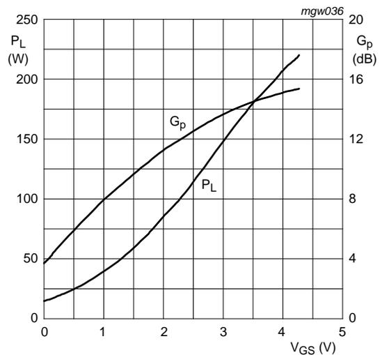
$V_{DS} = 36 \text{ V}$ ;  $I_{Dq} = 150 \text{ mA}$ ;  $P_i = 5.5 \text{ W}$ ;  $f = 1060 \text{ MHz}$ ;
